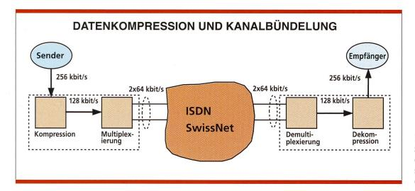
Bild 1. ISDN-Kapazität vervielfachen dank Datenkompression und Kanalbündelung.
