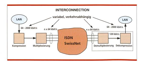
Bild 3. ISDN ist die billige und flexible Lösung für LAN-Interconnection.
