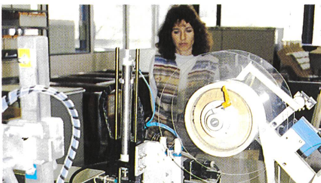
Bild 9. Vollautomatisch werden in dieser Anlage Disketten adressiert und versandbereit verpackt.
