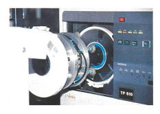
Bild 10. Industrieroboter bespielen Magnetbänder, adressieren und verpacken sie.
