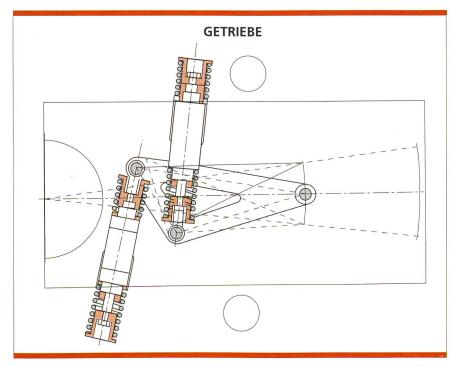
Bild 3. Dreipunkt-Schwenkgetriebe.
