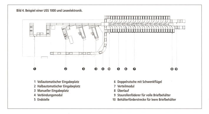
tere Sortiervorgänge verwendet werden können, wird ein Barcode erzeugt und auf ein Etikett gedruckt, das automatisch auf die Sendung aufgeklebt wird. Ist die Anschrift nicht automatisch lesbar, wird das Bild an einem Videocodierplatz der Codierkraft vorgeführt. Diese gibt über Tastatur die Sortierinformation, bei-
