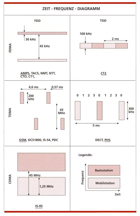
Bild 1. Zeit-Frequenz-Diagramm bezüglich der Mehrfachszugriffs- und Duplexiermethoden. Die angegebenen Zahlen entsprechen dem jeweils unterstrichenen System.
