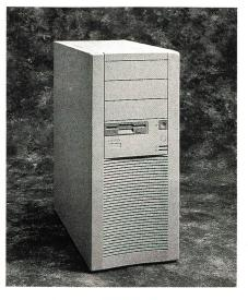
Der Low-End-Server SVI 5907 arbeitet mit einem 90-MHz-Pentium und bietet 4 ISA- und 3 PCI-Slots mit Plug&Play. Mit seinem kompakten Minitower-Gehäuse eignet er sich gleichermassen als High-End-Client.
