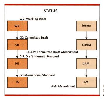
Fig. 5. Status d'une norme et de ses additifs.
