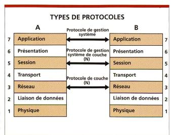
Fig. 9. Types de protocoles véhiculant des informations de gestion.
