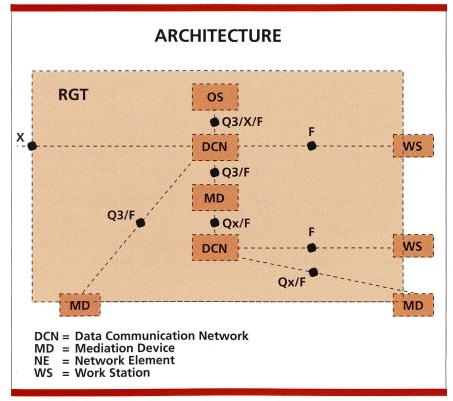
Fig. 16. Architecture physique du RGT.
