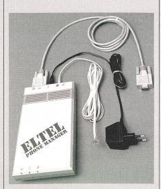
Das Gerät speichert die Daten aller Telefonate mit präziser Angabe von Datum, Zeit, Dauer, Rufnummer und Gebühren. Die so im RAM gespeicherten Daten – bis zu 2000 Telefonate – können mittels serieller Schnittstelle in einen IBM-kompatiblen Computer übertragen und dort mittels der dazugehörigen Software bearbei-
