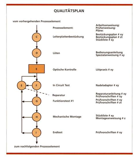
Bild 5. Der Qualitätsplan mit den vom Produkt zu durchlaufenden Teilprozessen [5].
