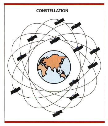
Fig. 1. La constellation de satellites GPS comprend 25 satellites en activité répartis sur 6 plans orbitaux.
