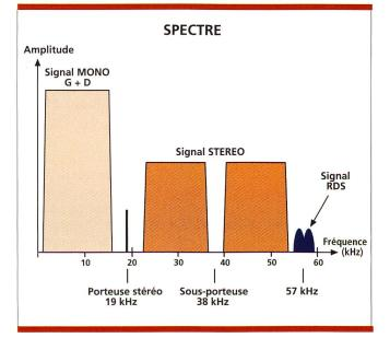
Fig. 5. Spectre du signal FM multiplex stéréo.
