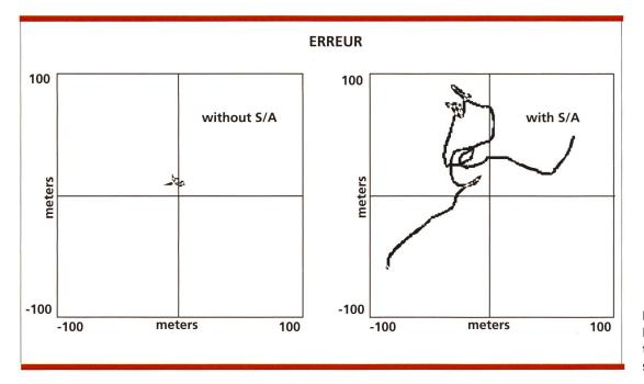
Fig. 2. Erreur de positionnement avec ou sans S/A.
