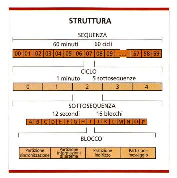
Fig. 1. Struttura del protocollo di trasmissione monocanale
