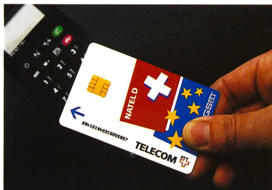
Fig. 7. La scheda SIM, la chiave personale di accesso alla rete GSM in formato carta di credito.
