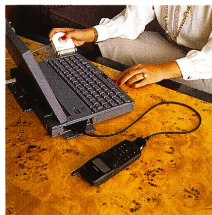
Fig. 12. Il sistema NATEL D permette di trasmettere e ricevere messaggi fax o dati quando si è in viaggio. A tale scopo è necessario disporre, oltre ad un telefono mobile adatto alla comunicazione dati, di un cosiddetto adattatore di linea – di solito una scheda PCMCIA – e dell'apposito programma di comunicazione.
