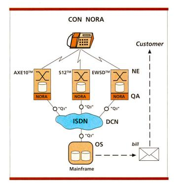
Fig. 4b. Il presente con NORA (esempio: trasferimento dei dati di tassazione).
