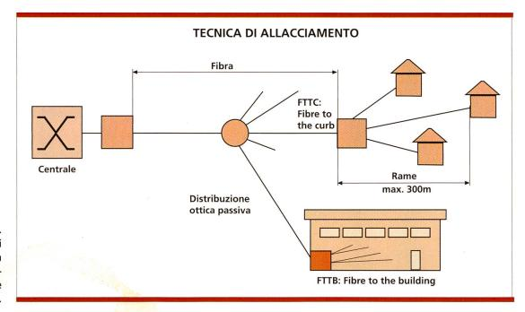
Fig. 1. Nuova tecnica di allacciamento con PON (Passiv Optical Network – rete ottica passiva).
