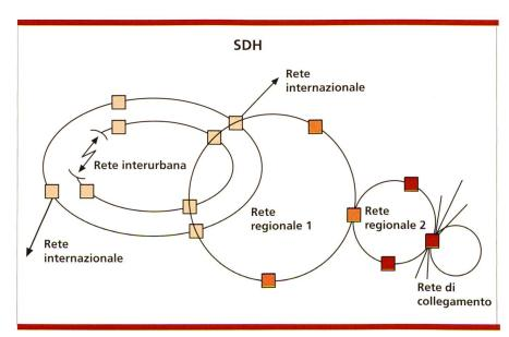
Fig. 3. SDH (Synchronous Digital Hierarchy – gerarchia sincrona digitale) a struttura anulare per la Rete 2000.
