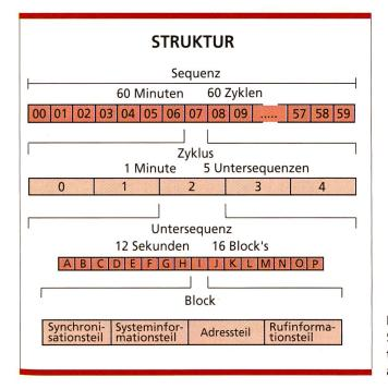
Bild 1. Struktur des Übertragungsprotokolls auf einem Kanal.
