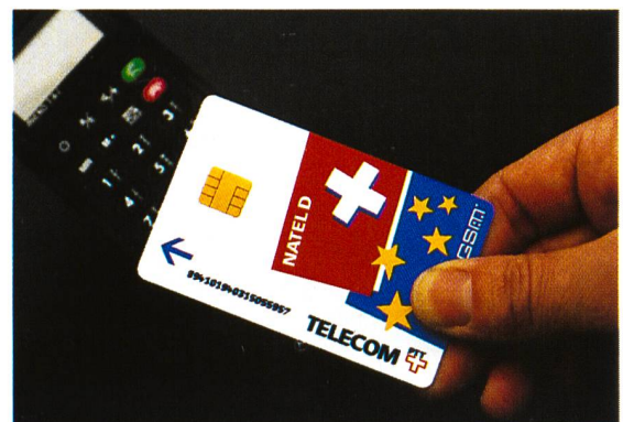
Bild 7. Die SIM-Karte im Kreditkartenformat, der persönliche Schlüssel zum GSM-Netz.
