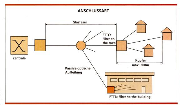
Bild 1. Neue Anschlussart mit PON (Passives Optisches Netz).
