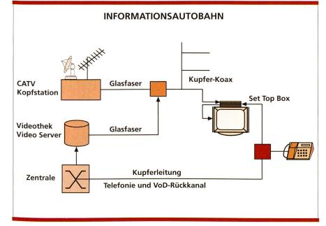
Bild 6. Informationsautobahn für Privatkunden durch Verknüpfung der Telecom und CATV-Netze.
