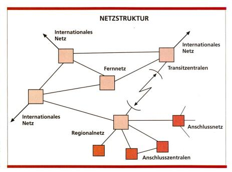
Bild 2. Heutige digitale Netzstruktur in PDH-Technik.
