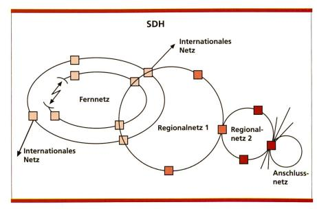
Bild 3. SDH (Synchrone Digitale Hierarchie) in Ringstrukturen für das Netz 2000.
