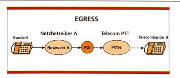
Bild 1. Die Telecom PTT terminiert den Verkehr des Netzbetreibers A zu seinem Telecom-Kunden B. POI: Point of Interconnection (z. B. Eingang oder Ausgang der Transitzentrale); Netzbetreiber: Drittfirma, die eine Konzession für den Betrieb eines Netzes besitzt; Netzwerk: eigenes oder mit Mietleitungen aufgebautes Netzwerk, das die Vermittlung und Übertragung von Informationen ermöglicht; Kunde A, B: Endkunde, der ein Endgerät in Form eines Telefon-, Fax- oder Datenübertragungsgerätes betreibt.
