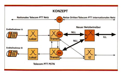
Bild 4. Das Bild zeigt, wie und wo die Netze der neuen Netzbetreiber durch Interconnection mit dem Netz der Telecom PTT zusammengeführt werden.
