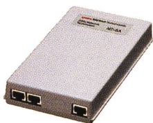
Für den Anschluss von ISDN-Geräten ans EuroISDN/SwissNet: NT-BA, Swiss Telecom Art. Nr. 312.002.9
