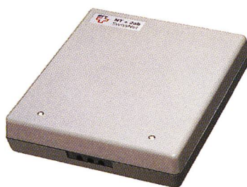
Für den Anschluss von ISDN- und Analog-Geräten ans Euro-ISDN/SwissNet: NT+2a/b, Swiss Telecom Art.Nr 212.016.0
