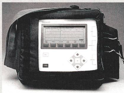
entwickelt wurde. Typischer Anwendungsbereich des TelScout sind die Breitbandnetze auf dem gesamten Kommunikationssektor. Mit der neuen Option 01 für den TelScout wendet sich Tektronix gezielt an neue Netzbetreiber auf dem expandierenden Breitbandkommunikationssektor: Das Wartungs- und Servicepersonal hat es dort mit beiden Kabeltypen zu tun. Das neue Messgerät lässt auch Messungen mit schmalen Impulsen zu (höhere Auflösung) und wartet mit einer neuen Auswertesoftware auf.
