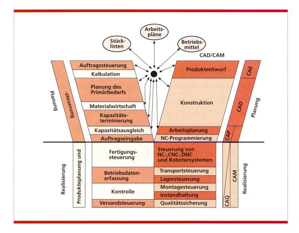
Bild 5. Das parallele Abwickeln der technischen Planung (CAD) und der betrieblichen Produktionsplanung (PPS) spart Zeit und hilft Synergien nutzen. Beide Pfade fliessen in die integrierte Produktion (CAM) ein.
