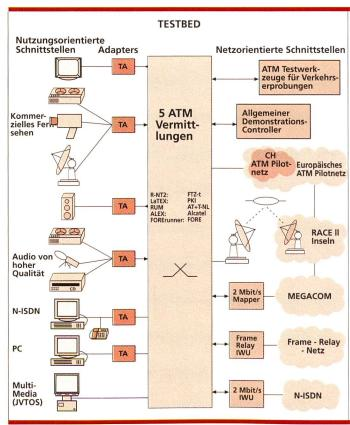
Bild 1. Exploit-Testumgebung
