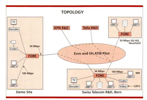
Bild 2. Topologie der Plattform ATM Corporate Networks
