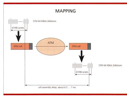
Bild 3. Umsetzung von 64-Kbit/s-Zellströmen auf ATM.
