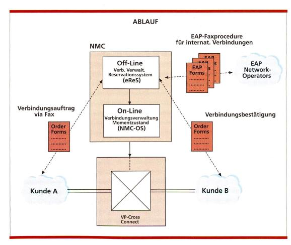
Bild 3. Ablauf einer Verbindungsbestellung.
