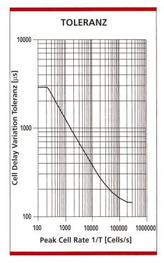
Bild 5. Cell Delay Variation Tolerance am Eingang des schweizerischen ATM-Netzes in Abhängigkeit von der Peak Cell Rate (provisorische Werte).
