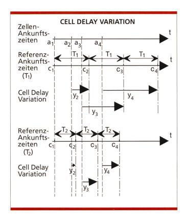
Bild 3. Cell Delay Variation derselben Zellenankunftszeiten für zwei verschiedene Peak Cell Rate (1/T<sub>1</sub> und 1/T<sub>2</sub>).
