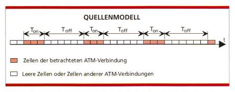
Bild 4. Quellenmodell für die Berechnung der Cell Delay Variation Tolerance (On-Off-Quellen).
