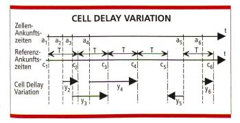
Bild 2. Illustration der Cell Delay Variation.
