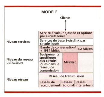
Fig. 1 Modèle d'un réseau de circuits loués (ML)
