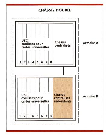
Fig. 6 Châssis double du SIMUX 3600
