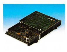
Fig. 8 La connexion de clients opérant jusqu'à 128 kbit/s via une paire de conducteurs de cuivre est réalisée au moyen de l'appareil de raccordement au réseau SIMUX 270x à l'aide d'interfaces clients correspondantes
