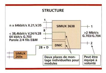
Fig. 7 Structure du système du SIMUX 3638
