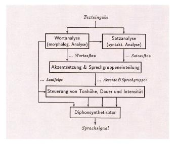
Fig. 2 Schéma bloc du système SVOX
