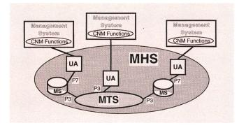
Fig. 7 Massage Handling System (MHS) für Kundennetzmanagement (CNM), basierend auf Prinzipien aus ITU-T-X.160.-Abkürzungen: MTS = Message Transfer System; MTA = Message Transfer Agent; Px = Protocol defined in X.400 series; MHS = Message Handling System; UA = User Agent; MS = Message Store
