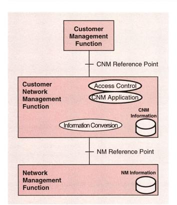
Fig. 5 Funktionale Architektur für Kundennetzmanagement (Customer Network Management – CNM) nach ITU-T X.160
