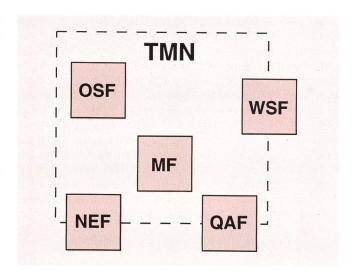
Fig. 2 Telecommunication Management Network (TMN). Funktionale Architektur, ITU-T M.3010.
