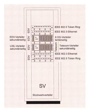
Fig. 9 Stockwerkverteiler bei grossen Gebäuden
