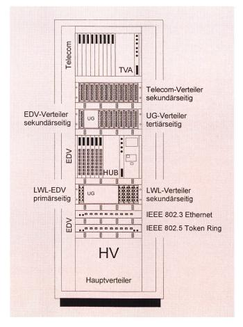
Fig. 8 Hauptverteiler bei grossen Gebäuden
