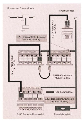
Fig. 16 Erdungskonzept der Stammstruktur, EDV-Telecom-Bereich
