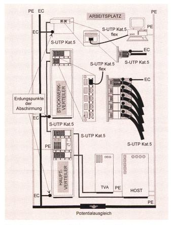
Fig. 23 Erdung und Schirmung bei Maschenstruktur
