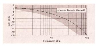
Fig. 29 Dämpfung (ATT) einer 100-m-Übertragungsstrecke [Paar 1]
