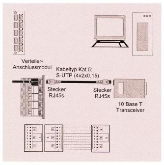
Fig. 39 Host-Verkabelung für IEEE 802.3 10Base T «Ethernet»
