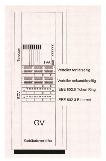
Fig. 13 Gebäudeverteiler bei kleinen Gebäuden mit universeller und S-BUS-Vernetzung
