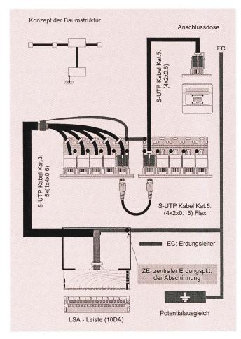
Fig. 15 Erdungskonzept der Baumstruktur, analoger Telecom-Bereich
