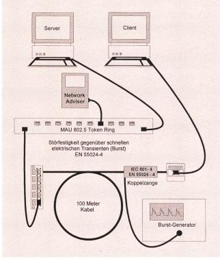
Fig. 35 Prüfaufbau zur Messung der Störfestigkeit nach EN 55024-4
