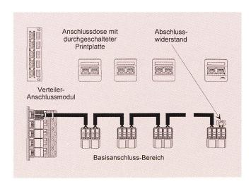
Fig. 36 ISDN-BUS-Übertragung im Basisanschlussbereich
