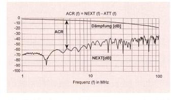
Fig. 31 Dämpfung zu Nebensprechverhältnis (ACR) einer 100-m-Übertragungsstrecke
