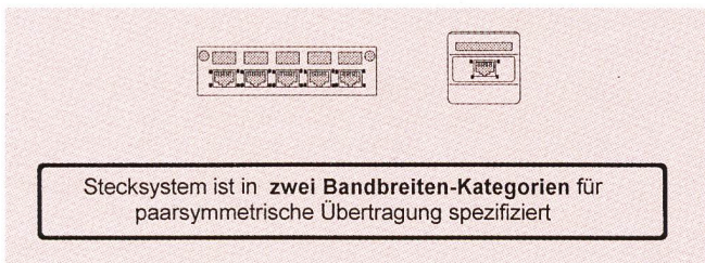
Fig. 26 Das Stecksystem ist in zwei Bandbreitenkategorien für paarsymmetrische Übertragung spezifiziert
