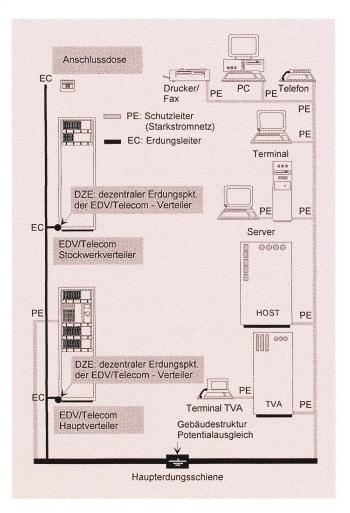
Fig. 20 Erdungs- und Schutzleiteranordnung (Stammstruktur)
