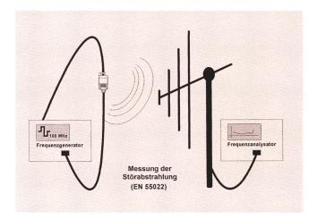
Fig. 34 Messung der Störabstrahlung nach EN 55022
