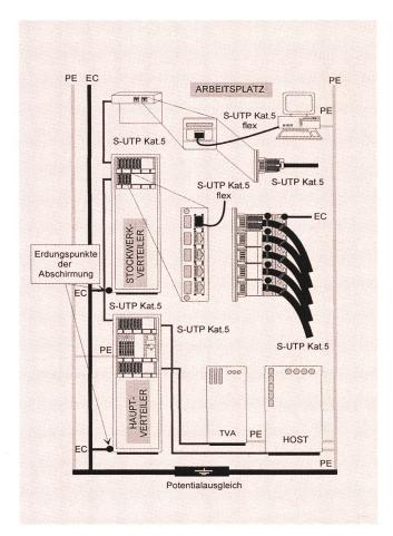
Fig. 21 Erdung und Schirmung bei Stammstruktur
