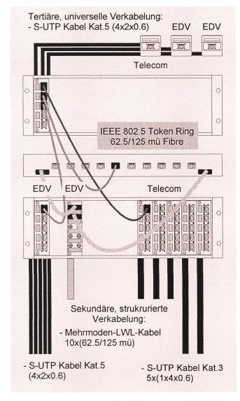
Fig. 11 Elektrisches und optisches Verteilerfeld im Stockwerkverteiler mit universeller Aufschaltmöglichkeit zur Arbeitsplatzanschlussdose
