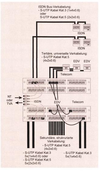
Fig. 14 Elektrisches Verteilerfeld im Gebäuderverteiler mit universeller und S-BUS-Aufschaltmöglichkeit zur Arbeitsplatzanschlussdose
