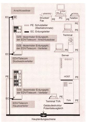
Fig. 22 Erdungs- und Schutzleiteranordnung (Maschenstruktur)
