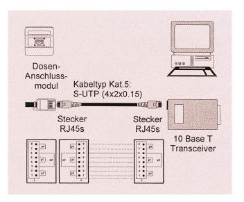
Fig. 38 Arbeitsplatzverkabelung für IEEE 802.3 10Basae T «Ethernet»
