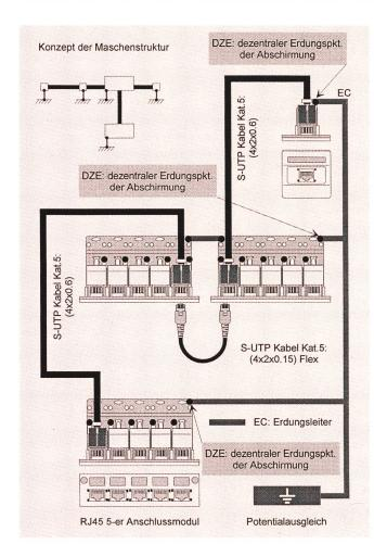
Fig. 17 Erdungskonzept der Maschenstruktur, EDV-Telecom-Bereich
