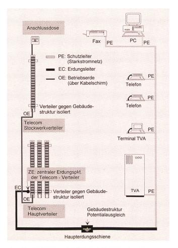
Fig. 18 Erdungs- und Schutzleiteranordnung (Baumstruktur)
