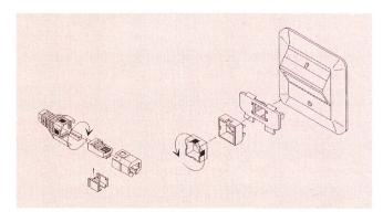
Fig. 6 Ausführungsform der nachrüstbaren Codierung für die Arbeitsplatzanschlussdose und das Verteilerfeld
