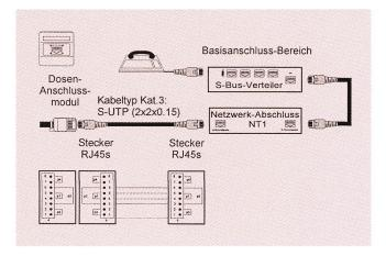
Fig. 37 Universelle und BUS-Verkabelung im Arbeitsplatzbereich
