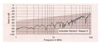
Fig. 30 Nahnebensprechdämpfung (NEXT) einer 100-m-Übertragungsstrecke [Paar 3 & 4]
