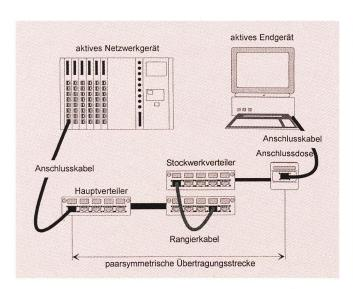
Fig. 27 Definition einer paarsymmetrischen Übertragungsstrecke
