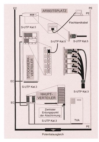
Fig. 19 Erdung und Schirmung bei Baumstruktur
