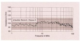
Fig. 28 Wellenimpedanz (Z) einer 100-m-Übertragungsstrecke [Paar 1]
