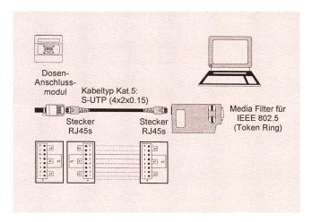
Fig. 40 Arbeitsplatzverkabelung für IEEE 802.5 «Token Ring»
