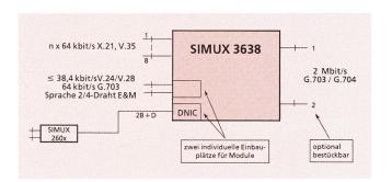
Fig. 7 Systemaufbau des SIMUX 3638
