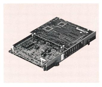
Fig. 5 E3-Baugruppe mit zwei Leitungs-Interfaces für die effiziente Vernetzung der Cross-Connect SIMUX 3645 mit 34 Mbit/s-Verbindungen
