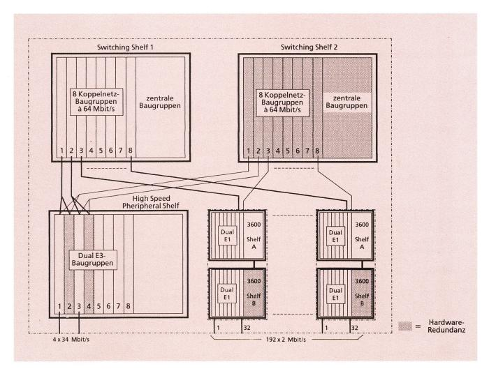
Fig. 4 Typische Systemkonfiguration des SIMUX 3645
