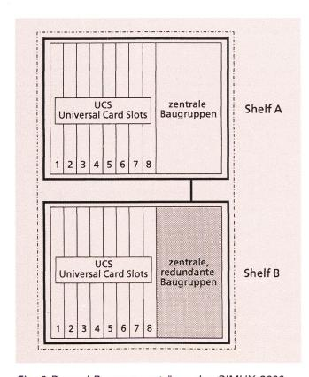
Fig. 6 Doppel-Baugruppenträger des SIMUX 3600
