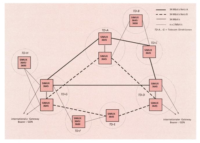
Fig. 9 Netzdesign Backbone MilaNet in der Fernnetzebene
