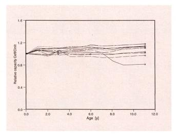
Fig. 6 Comportement de la capacité relative Ceff/Cinit en fonction de l'âge de l'accumulateur, pour des tensions de maintien de la charge comprises entre 2,18 et 2,30 V par élément et une température d'environnement égale à 20°C. La teneur en antimoine de l'électrode positive des accumulateurs conventionnels considérés dans ce graphique est comprise entre 0,0 et 2,7 %. La désignation des courbes est indiquée dans la légende de la figure 4
