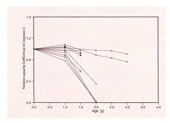
Fig. 9 Comportement de la capacité relative Ceff/ Cinit des accumulateurs étanches à soupapes, testés dans notre laboratoire, en fonction de l'âge de l'accumulateur, pour des tensions de maintien de la charge comprises entre 2,15 et 2,21 V par élément et une température d'environnement égale à 40°C. Désignation des courbes (numéro de l'accumulateur/tension [VI):
