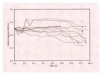
Fig. 3 Comportement de la capacité relative Ceff/ Cinit en fonction de l'âge de l'accumulateur, pour des tensions de maintien de la charge comprises entre 2,18 et 2,25 V par élément et une température d'environnement égale à 20°C. La teneur en antimoine de l'électrode positive des accumulateurs conventionnels considérés dans ce graphique est comprise entre 3,5 et 10 %. La désignation des courbes est indiquée dans la légende de la figure 1
