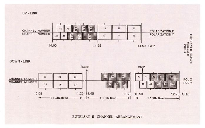
Fig. 6 Eutelsat II, Transponder-Konfiguration
