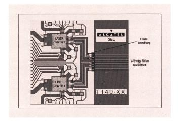
Fig. 6 Schematische Darstellung der Silizium-Mutterplatine für einen Mehrkanalsender (Abmessungen: 12,5 x 14,5 mm)
