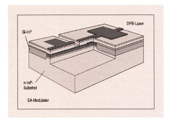
Fig. 4 Integrierter Laser und externer Absorptionsmodulator
