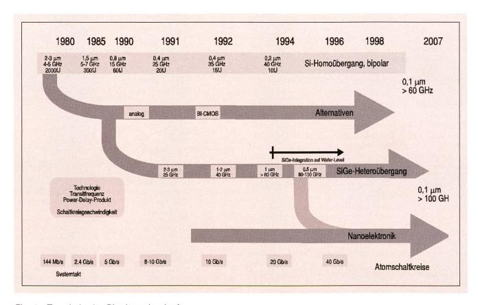
Fig. 1 Trends in der Bipolartechnologie
