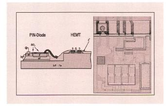
Fig. 5 Integrierter OE-Empfänger
