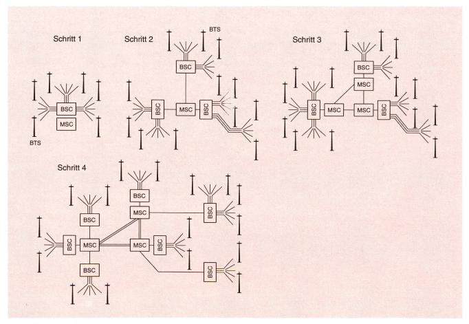
Fig. 12 Netzkonzept «Schrittweiser Ausbau»
