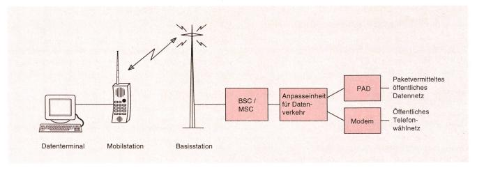
Fig. 10 Anpassung der Datenübertragung an die Standards MSC Mobile Switching Centre – Zentrale für Mobiltelefonie
