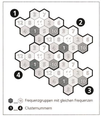
Fig. 7 GSM-Zellennetz – Frequenzplanung 12er Cluster
