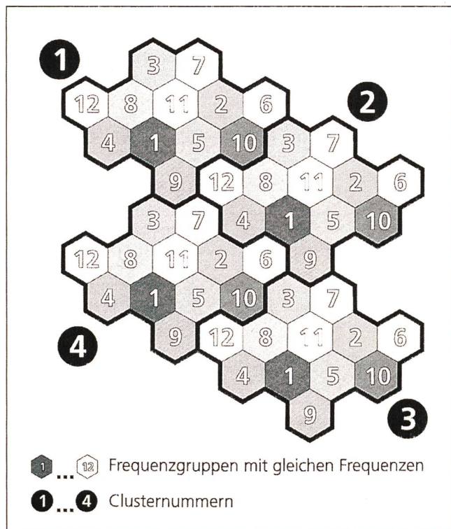
Fig. 7 GSM-Zellennetz – Frequenzplanung 12er Cluster
