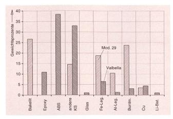
Fig. 1 Stoffliche Zusammensetzung der Telefonapparate Modell 29 und Valbella. Der Vergleich zeigt deutlich die Zunahme des Kunststoffanteils beim heutigen Apparat Valbella
