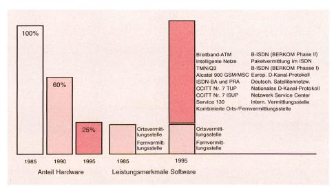
Fig. 4 Entwicklungsaufwand und Veränderung der Hardware und Software bei den digitalen Vermittlungssystemen
