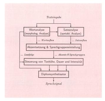
Fig. 2 Schema a blocchi del sistema di sintesi della voce SVOX
