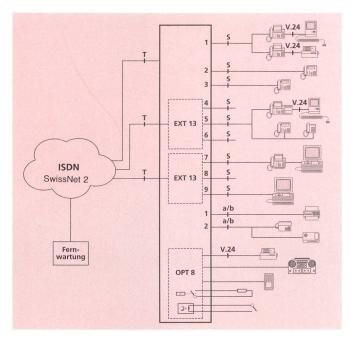
Fig. 1 Anschlusskonzept und Systemkonfiguration Ascotel bcs 8
