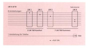
Fig. 10 Teamanlage in analoger Linienwählertechnik
