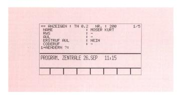
Fig. 3 Erste Menüseite der Teilnehmeranschlussprogrammierung
