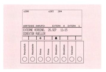
Fig. 7 Crystal als Vermittlerapparat: Anzeige der Linienzustände
