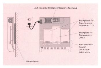
Fig. 2 Mechanischer Aufbau des Ascotel bcs 8
