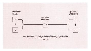
Fig. 2 Fernübertragungsstrecken mit optischer Frequenzmultiplextechnik
