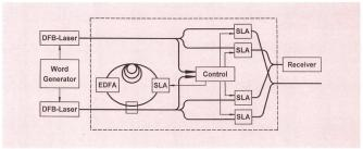
Fig. 14 Versuchsaufbau eines transparenten optischen 2×2-ATM-Schaltknotens für 1 Gbit/s SLA Semiconductor Laser Amplifier — Halbleiter-Laserverstärker
