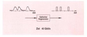
Fig. 7 Optischer Signal-Regenerator, 10 Gbit/s
