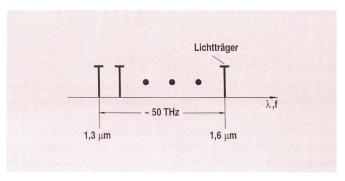
Fig. 1 Übertragungskapazität von Lichtwellenleitern
