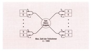
Fig. 4 Lokales Datennetz (Local Area Network, LAN) mit optischer Frequenzmultiplextechnik
