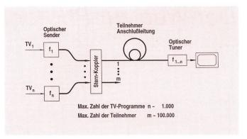
Fig. 3 Fernsehverteilnetz mit optischer Frequenzmultiplextechnik
