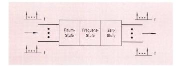
Fig. 9 Optische Vermittlungseinrichtung
