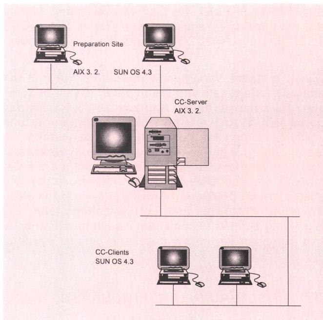
*Fig. 2 Betriebssysteme im Testaufbau — Systèmes d'exploitation dans la configuration de test*
