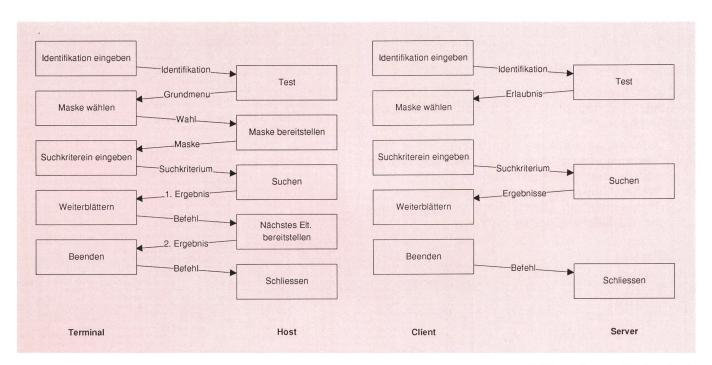
Fig. 6 Kommunikationsdiagramme einer Datenbankabfrage mit Terminal-Host- und Client-Server-Technologie
