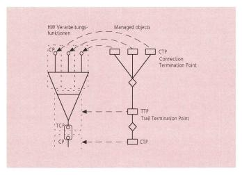
Fig. 13 Korrespondenz zwischen Hardware-Verarbeitungsfunktionen (Ressourcen) und verwalteten Objekten
