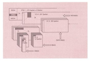
Fig. 15 Aufbau des synchronen Transportmoduls STM-1 aus Signalen der plesiochronen digitalen Hierarchie
