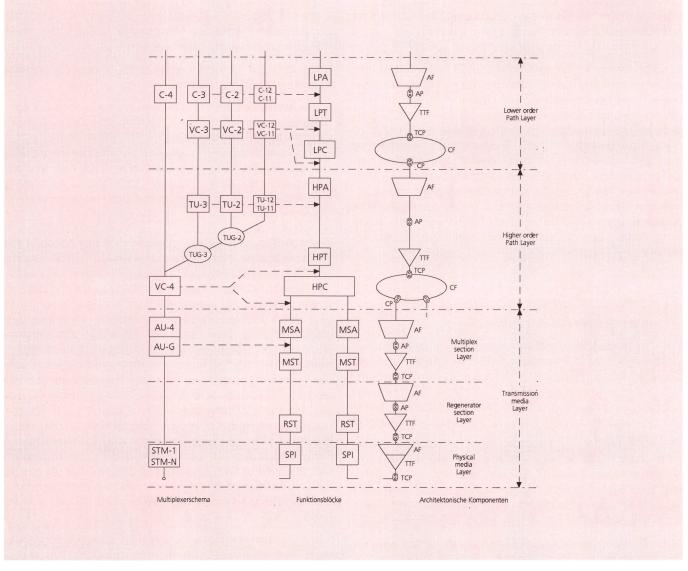
Fig. 1 SDH-Multiplexschema mit zugehörigen Funktionsblöcken und architektonischen Komponenten
