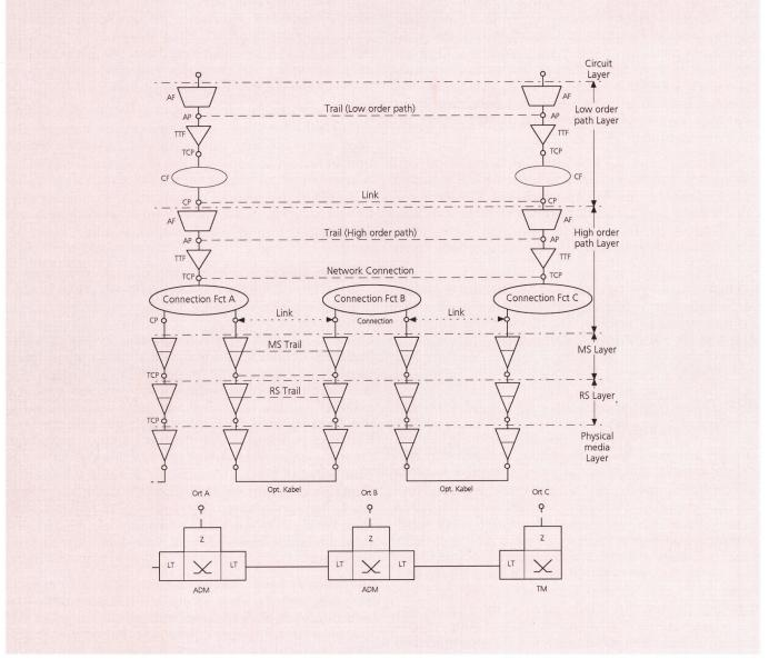
Fig. 6 Beispiel einer modellierten SDH-Strecke mit zwei Add-Drop-Multiplexern und einem Terminal-Multiplexer
