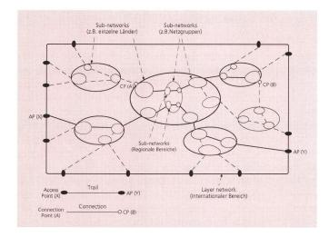
Fig. 4 Unterteilung eines geschichteten Netzes und der Unternetze (Sub-Network)
