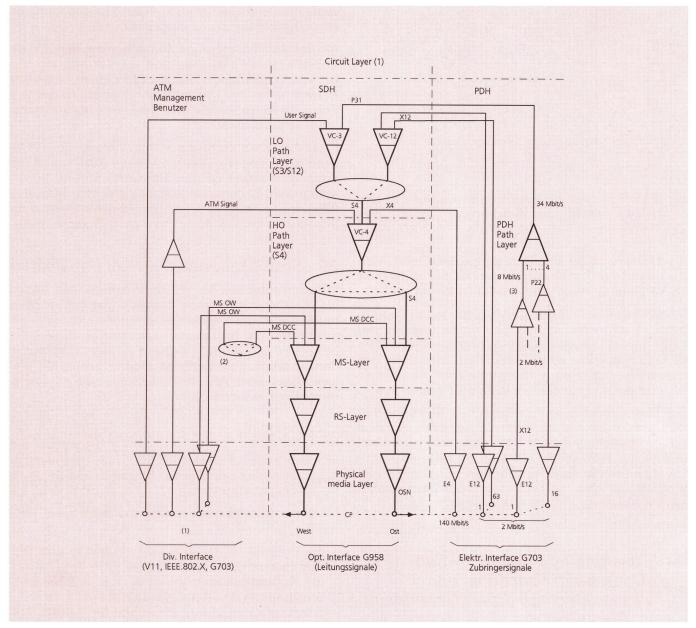
Fig. 9 Modellierung eines Add-Drop-Multiplexers (vereinfacht)
