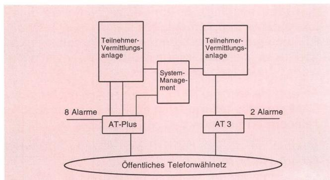
**Fig. 3 Anschluss der Module AT-Plus und AT3 an vernetzten TVA mit angeschlossenem TVA-Systemmanagement — Raccordement des modules AT-Plus et AT3 à des ACU intercon-nectés avec systèmes de gestion des ACU raccordés**
