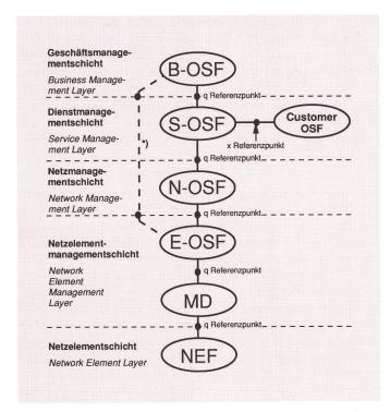
Fig. 1 Beispiel einer funktionalen OS-Hierarchie [aus ITU-T M.3010]
