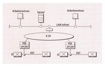
Fig. 4 Architecture du système VEMA International (réalisation locale par CI)
