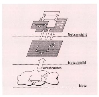
Fig. 6 Relation entre le réseau, la configuration du réseau et les vues du réseau spécifiques à l'utilisateur
