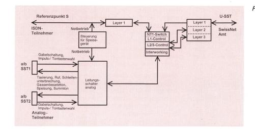
g. 4 Schnittstellen der Ablaufsteuerung Interworking – Zusammenwirken L1 Control – Schicht-1-Steuerung Layer – Schicht
