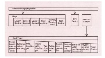
Fig. 3 Softwarestruktur der Ablaufsteuerung
