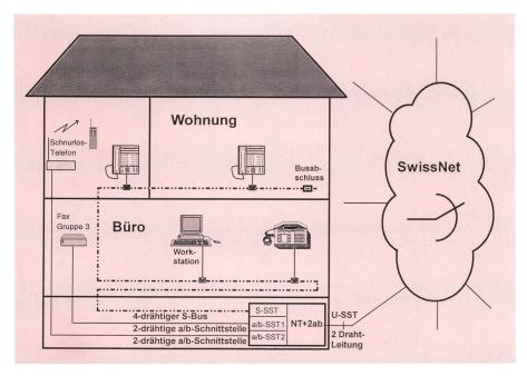
Fig. 1 Hausinstallation mit digitalen und analogen Endgeräten am SwissNet. Als Netzabschlussgerät wird das neue NT+2ab eingesetzt
