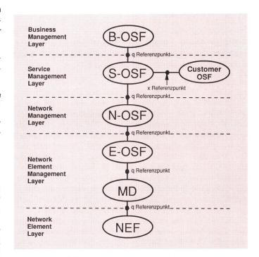
Fig. 7 Beispiel einer funktionalen OS-Hierarchie (aus ITU-T M.3010)
