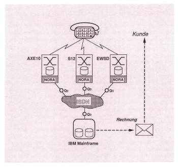
Fig. 10 TMN-Anwendung für den normierten Rechneranschluss Nora
