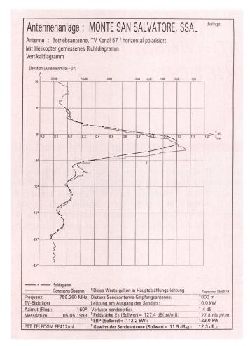
Fig. 2 Vertikaldiagramm (Beispiel)
