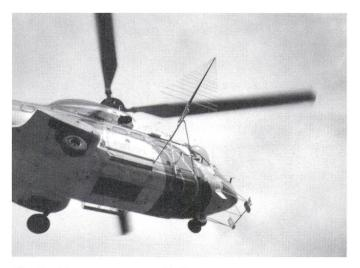
Fig. 9 Messantenne am Helikopter
