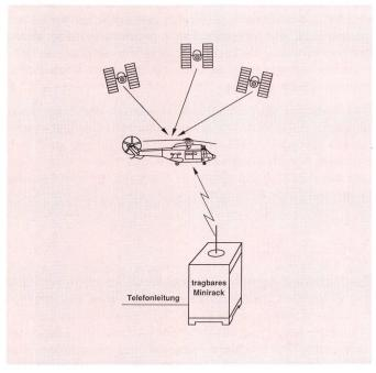
Fig. 6 Korrekturdatenübertragung bei differentieller GPS-Navigation
