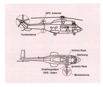
Fig. 5 Antennemontagepunkte am Helikopter
