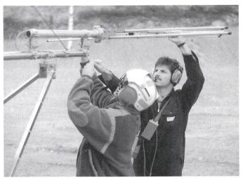
Fig. 8 Montage der Messantenne im Freien
