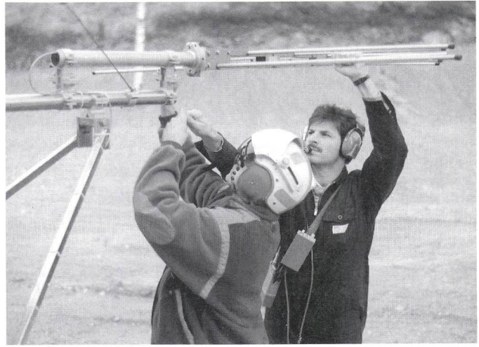
Fig. 8 Montage der Messantenne im Freien
