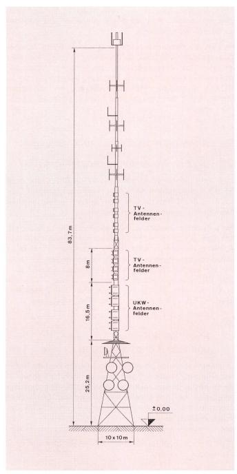
Fig. 3 Sendeturm mit Antennenfeldern
